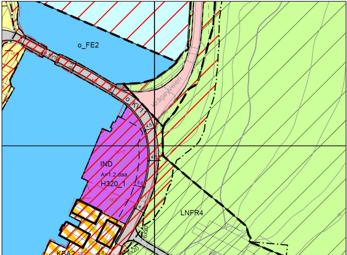
Figur 11: Forslag til utvidet svingradius i kryss Leiasundveien og Krågøyveien. Utsnitt av planforslag og gjeldende planer.
