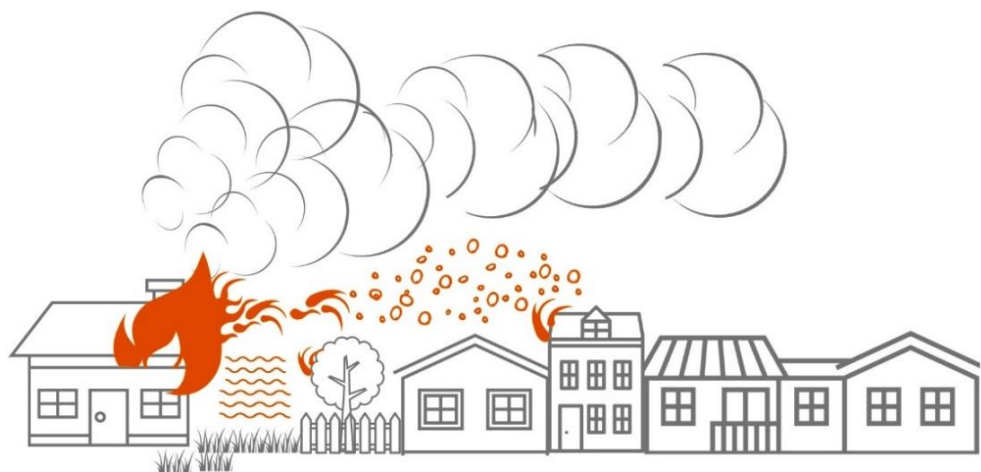
Figur 3: Illustrasjon av brannspredning som følge av stråling, flammekast og flyvebrann.
