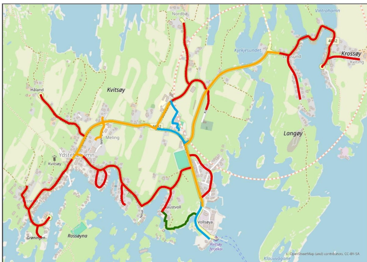
Figur 5. Kart over eksisterende infrastruktur for myke trafikanter i Kvitsøy kommune. Fargekoder: oransje - fortau, blå - gang-/sykelsti, rød - blandet trafikk, grønn - tursti
