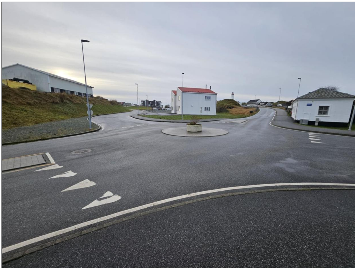
Figur 28. Rundkjøring like ved Kvitsøy kommunehus., tatt 09.12.2025 av Tormod Høie Meling. På grunn av lav trafikkmengde, og for å forbedre forholdene for myke trafikanter burde den ombygges til opphøyet kryss.
