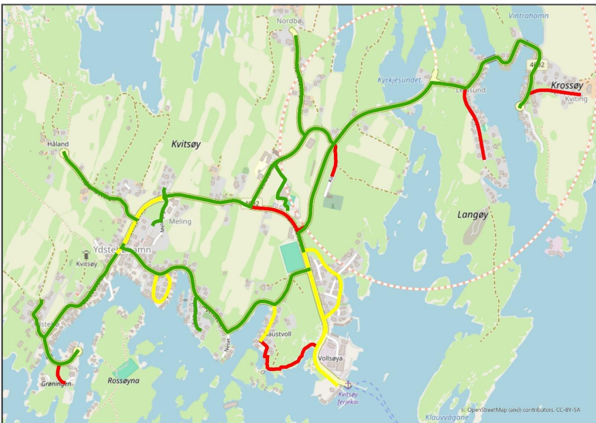
Figur 10. Kart som indikerer kvaliteten på veidekke. Fargekoder: rød - lav kvalitet, gul - tilstrekkelig kvalitet, grønn - bra kvalitet.
